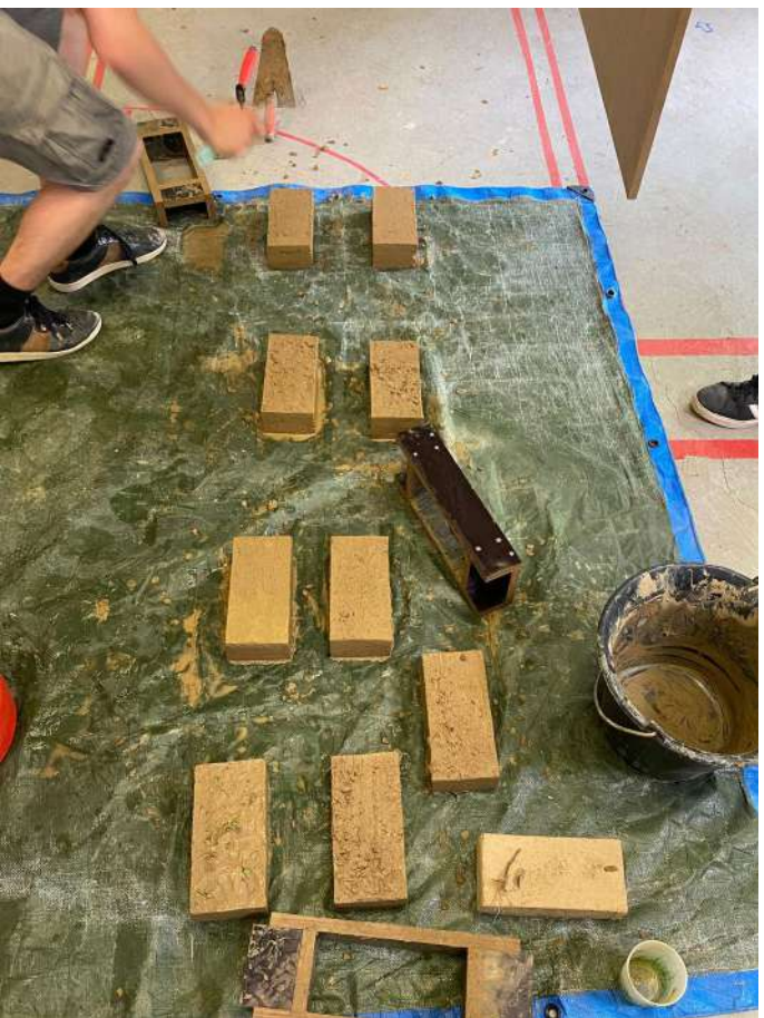
Atelier briques de terre crue
