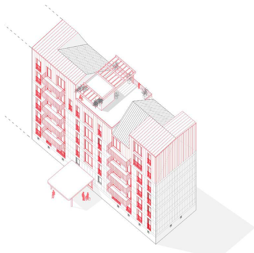
Projet de réhabilitation des « barres » : ▲ nouvelles partitions intérieures et surélévations
