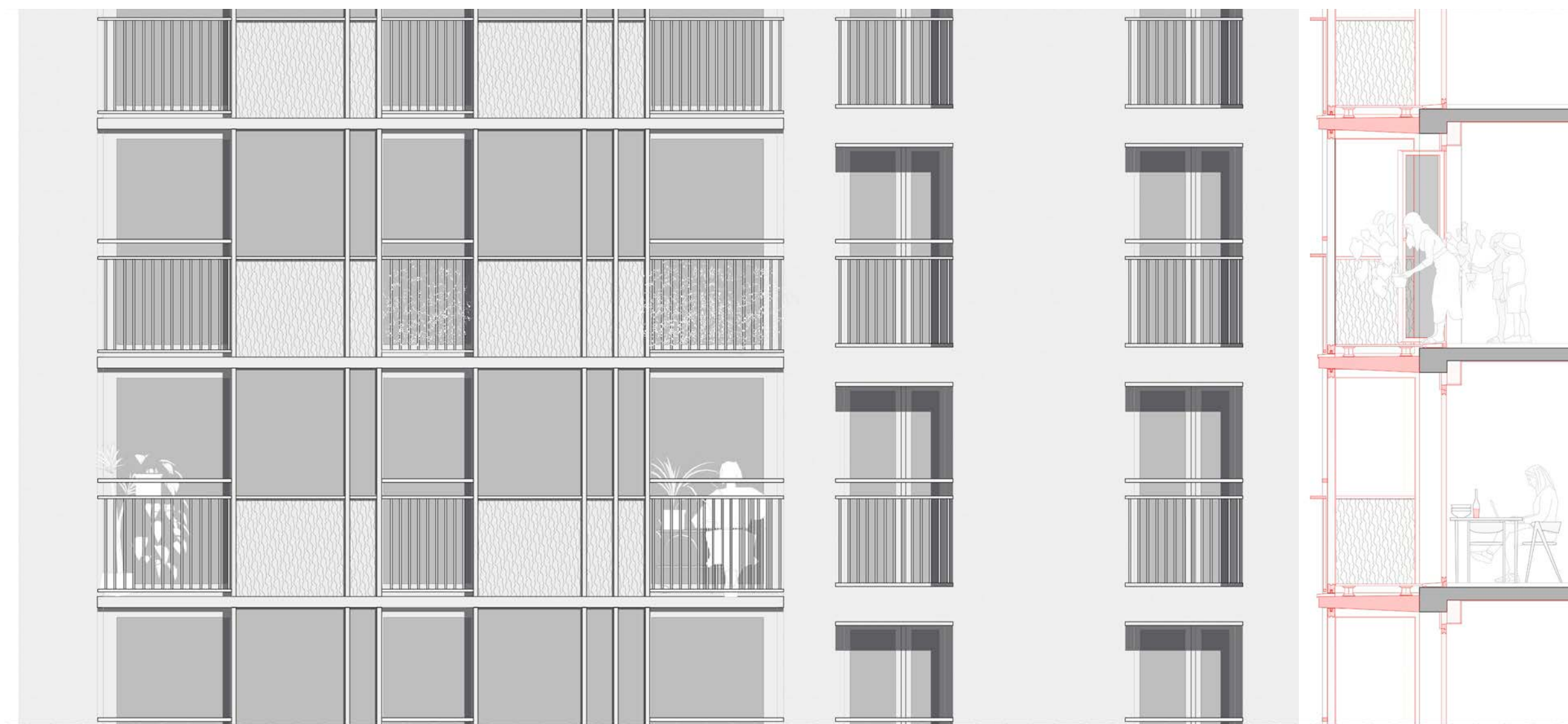
Façades en béton préfabriqué retrouvées grâce à l'emploi d'une isolation par l'intérieur ; ▲ augmentation de la hauteur des baies et amélioration des loggias existantes
