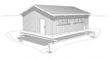
Placer les poutres en acier et les vérins hydrauliques sous les fondations
