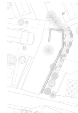
1. Nettoyage du site, installation de la plateforme d'accès et réactivation du canal
