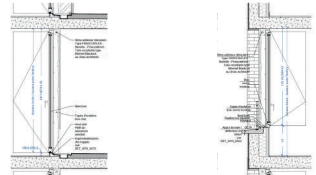
Détails de composition de façade courante
