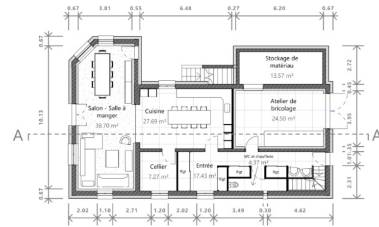
Plan du RDC rénovation ech. 1/200
