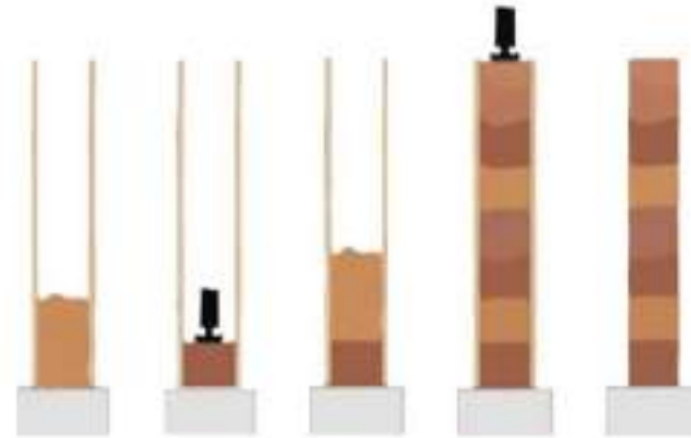
murs en pisé
