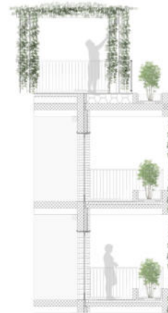
Détails et traitement de la double peau: moucharabieh, brise-soleil
