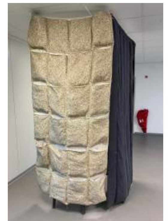
Rideau thermique à deux pans pour créer un sas d'entrée
