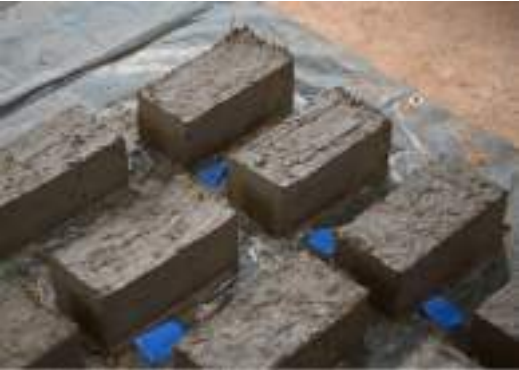
Matrice d'adobe dans le but de déterminer le dosage optimal
