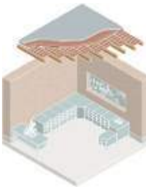
BAUGE TERRE ARGILEUSE MÉLANGÉE À LA MAIN AVEC DES FIBRES VÉGÉTALES, MIS EN TAS UN MODULE \approx 35\text{m}^3 DE BAUGE ÉPAISSEUR DU MUR: 60cm
