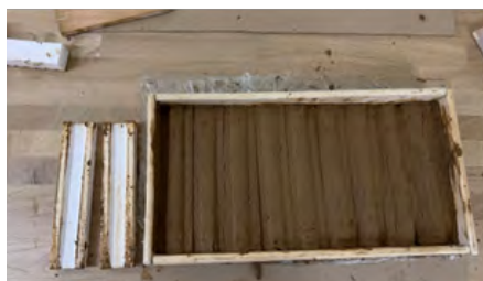
Fig 6 : Création des textures avec des moules imprimée en 3D
