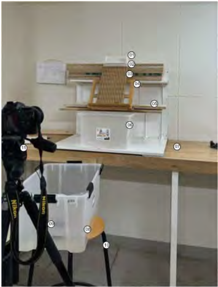
1-Déversoir 2-Zone de transition 3-Echantillon de terre 4-Support incliné 5-Réhausseur 6-Bac de récupération 7-Plan de travail 8-Réservoir d'eau 9-Pompe à eau 10-Support 11-Appareil photo
