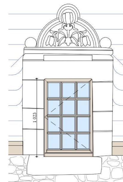
Dessin de lucarne LE25 recomposée - PROJET.
