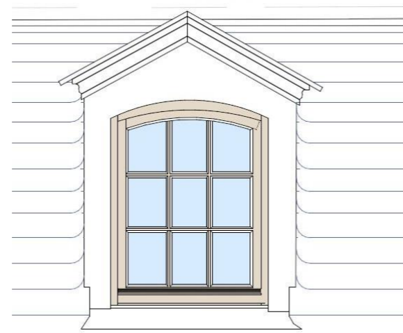
Dessin d'une lucarne recomposée - PROJET.
