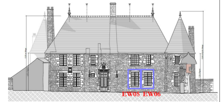
Façade ouest - côté cour - repérage des menuiseries de type 1
