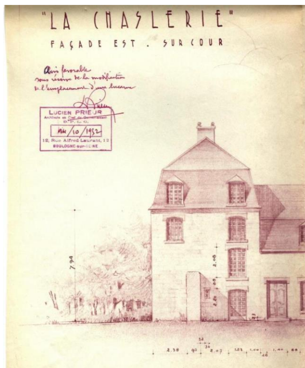
Plan de projet pour le percement des baies sur la façade est des écuries.
