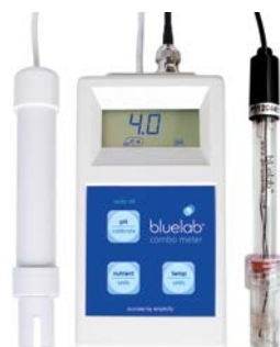
Calibración de pH7 y pH4 realizada correctamente
