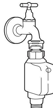
Tuyau d'alimentation de sécurité
