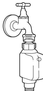
Mangueira de abastecimento de segurança
