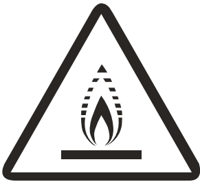
Advertencia: material de combustión lenta (Para los productos que contienen refrigerante R32, cumplir únicamente la norma IEC 60335-2-40:2018)
