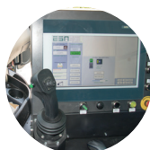
Joystick de mando y panel electrónico principal.
