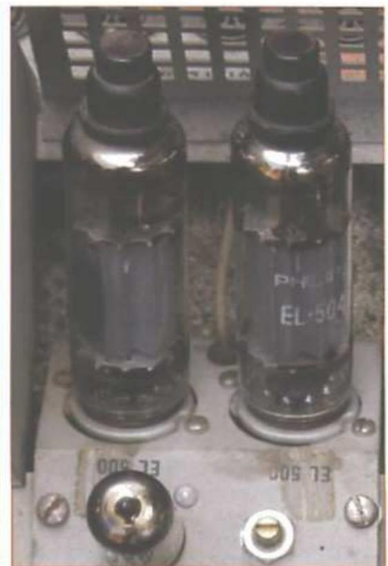
**Le Telewatt V-71 frappe d'emblée par la position inusitée de ses tubes de puissance (ici des EL504). Cet arrangement original permet de réduire l'encombrement hors tout de l'appareil et d'assurer une parfaite ventilation des tubes**
