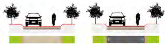
Percorso promiscuo ciclabile e veicolare: stabilizzato misto cava (a sinistra) e bitume (a destra)
