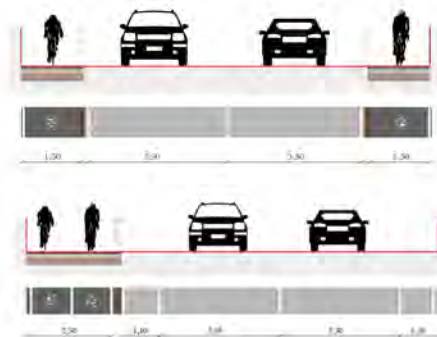
Pista ciclabile in sede propria: monodirezionale (in alto) e bidirezionale (in basso)
